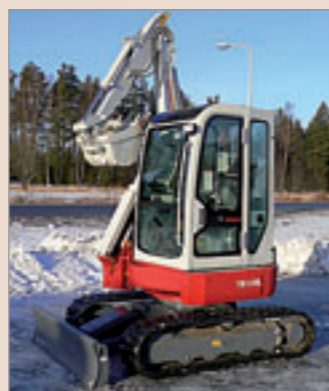
Lyhytperäinen, neljän tonnin painoinen Takeuchi TB138 FR on todella ahtaiden paikkojen kone. Puomi nousee erittäin pystyyn.
